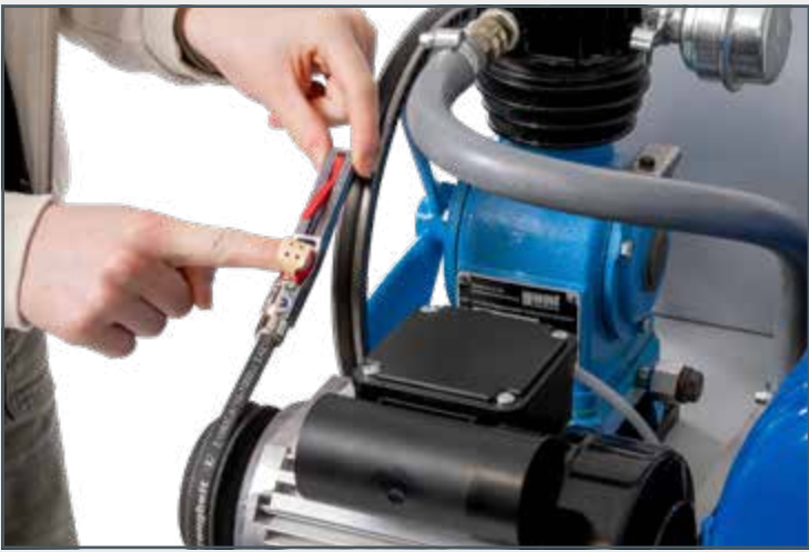
Comprobación de la tensión de la correa
