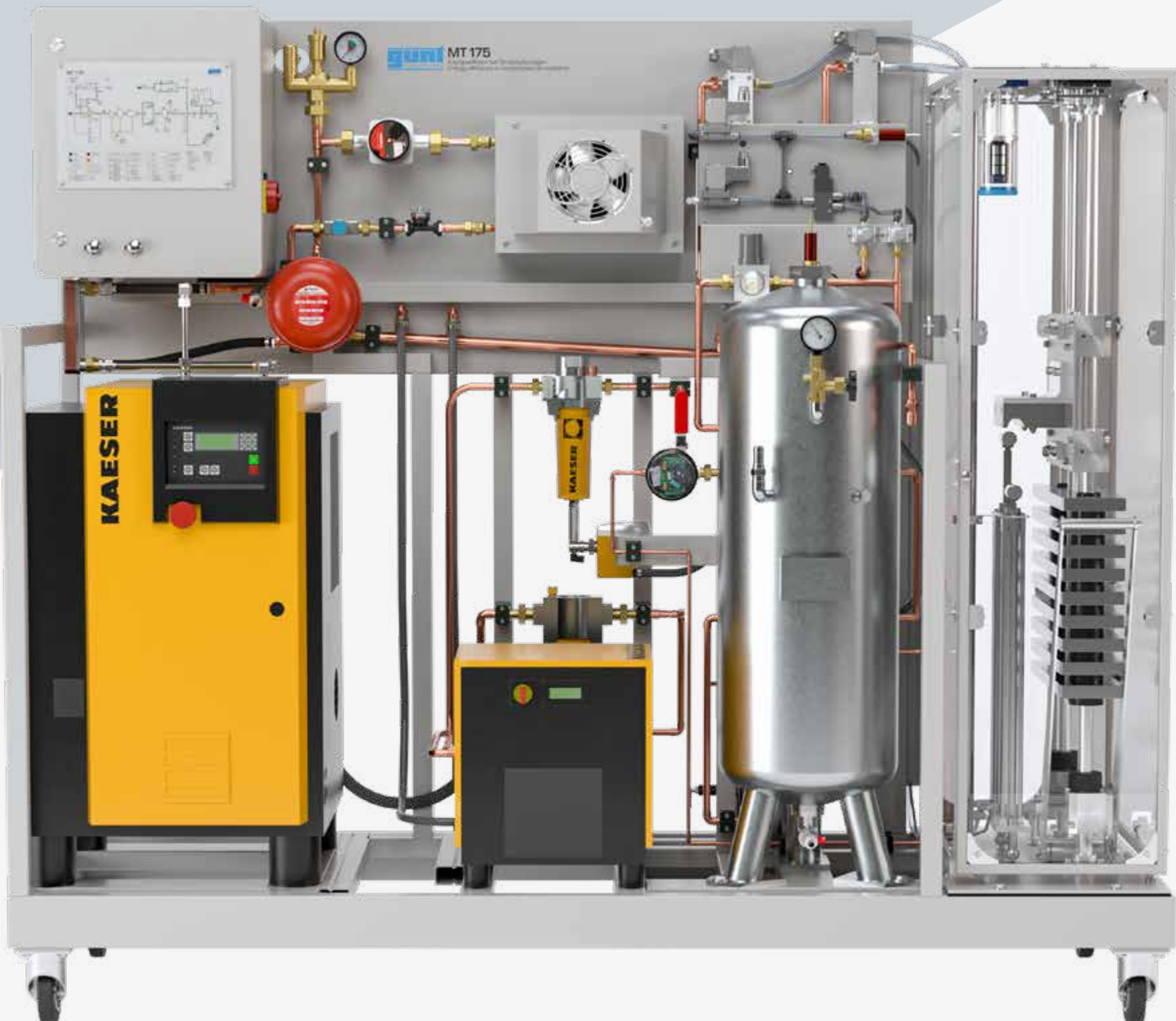
MT 175 Eficiencia energética en las instalaciones de aire comprimido
